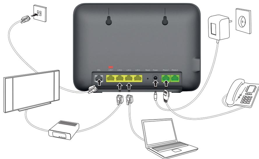
1. Telefonski kabel koji je spojen u telefonsku utičnicu sada više ne spajate u telefon, nego u DSL priključak modema.
