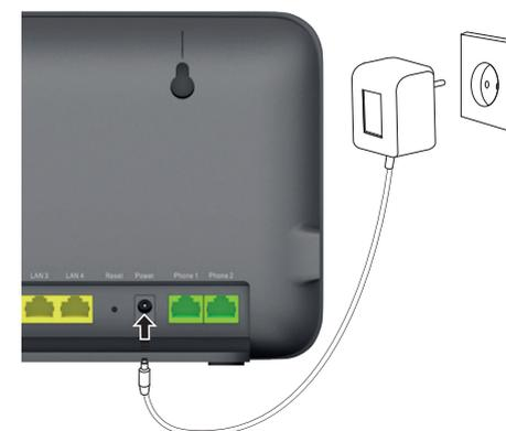
5. Spojite modem u strujnu utičnicu sa strujnim adapterom.
